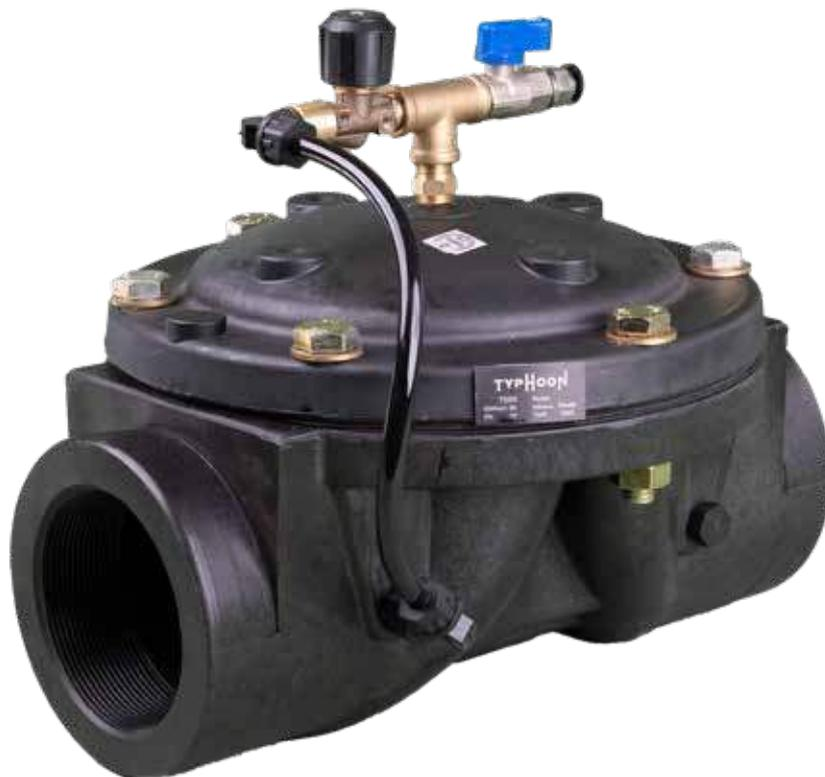
Le valvole a comando manuale sono valvole di controllo idraulico azionate dalla pressione di linea e forniscono mini valvole a 3 vie per il funzionamento on-off. La valvola ha una pressione minima di apertura di 0,7 bar. Grazie alla sua membrana flessibile, esegue un'operazione di controllo facile e veloce in applicazioni ad alta pressione e si chiude senza urti.
