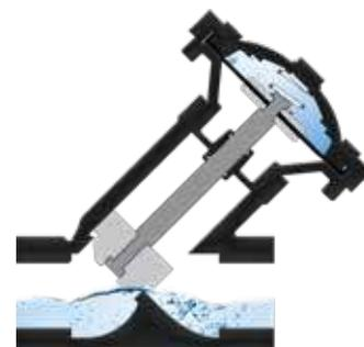
La valvola di fondo viene utilizzata per prevenire il reflusso che si verifica quando la pompa viene spenta. Reagisce rapidamente grazie al suo sistema a lamelle. Fornisce una chiusura silenziosa, non impattante e a prova di perdite.
