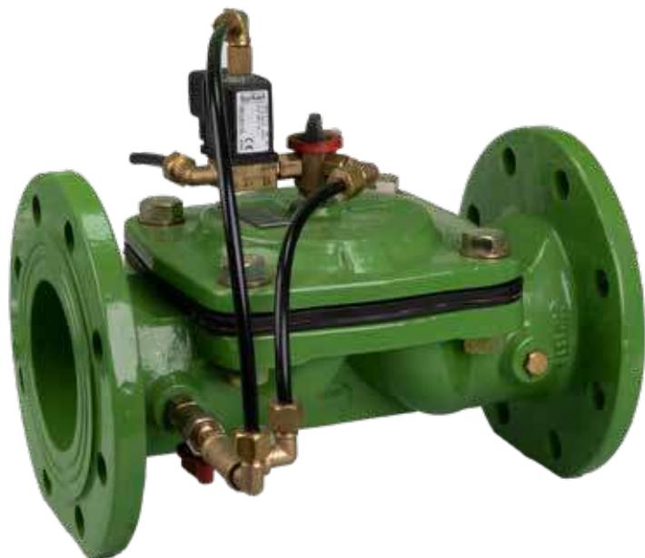
L'électrovanne est une vanne de commande hydraulique actionnée par la pression de la ligne et conçue pour assurer le processus d'ouverture/fermeture au moyen d'électrovannes pilotes 3/2 intégrées, commandées à distance par un signal électrique. Le signal électrique pour les électrovannes pilotes est assuré par un dispositif de contrôle, un relais temporisé, un interrupteur principal et des unités de contrôle PLC, etc.
