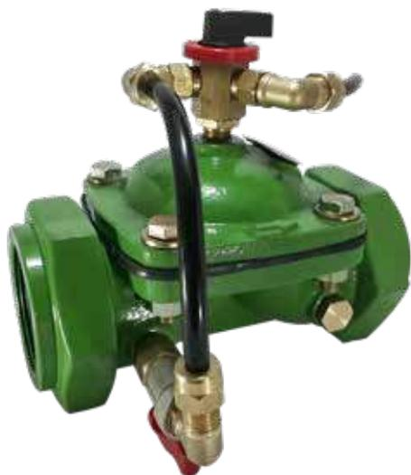
Les vannes à commande manuelle sont des vannes de commande hydrauliques qui sont actionnées par la pression de la ligne et fournissent des mini-vannes à 3 voies pour le fonctionnement tout ou rien. La pression d'ouverture minimale de la vanne est de 0,7 bar. Grâce à son diaphragme flexible, elle permet une vérification facile et rapide dans les applications à haute pression et se ferme sans impact.
