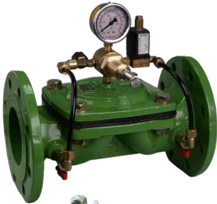
Le détendeur-régulateur de pression commandé par solénoïde est une vanne de commande hydraulique qui réduit la valeur de la pression d'entrée à la valeur de la pression souhaitée. La commande de la vanne principale est effectuée par des bobines de solénoïde montées sur celle-ci.
