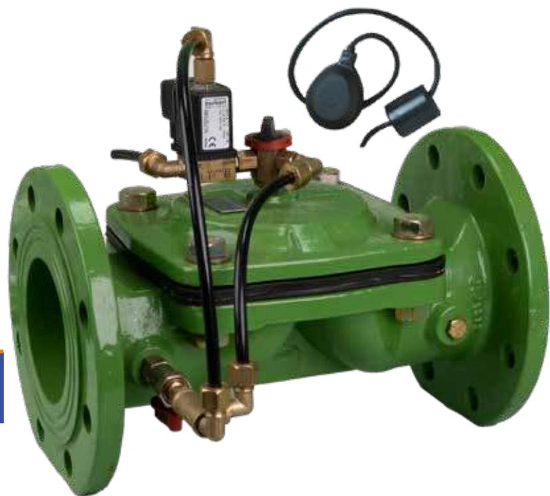
La vanne de contrôle de niveau à flotteur électrique est une vanne qui contrôle en permanence le niveau d'eau grâce à un flotteur électrique placé dans le réservoir. Lorsque le niveau d'eau au fond du réservoir tombe en dessous de la valeur souhaitée, le flotteur électrique envoie un signal à la bobine solénoïde de la vanne principale.
