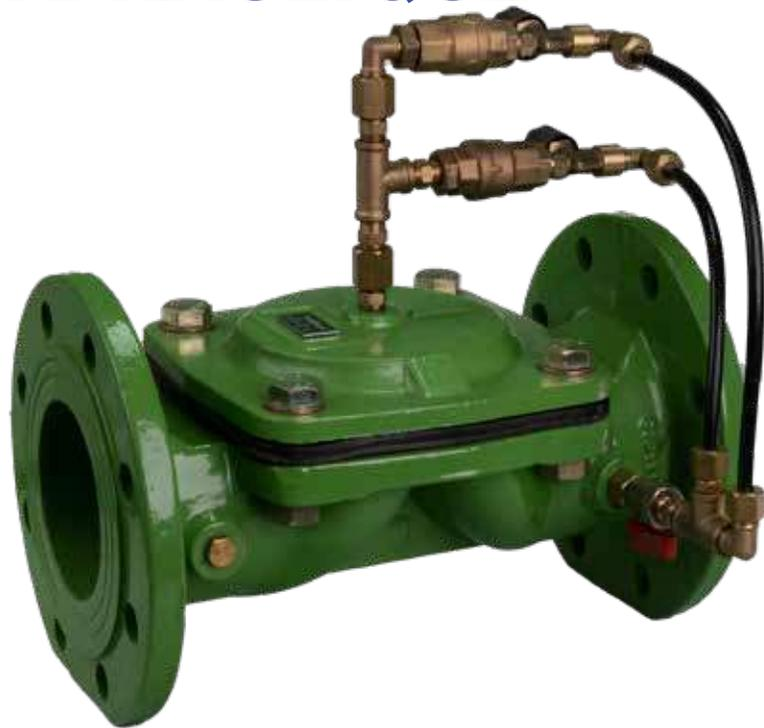
Le clapet anti-retour hydraulique est un clapet anti-retour à commande hydraulique qui fonctionne avec la pression de la ligne et empêche le reflux dans le système. Lorsque la pression aval est supérieure à la pression amont, le clapet se ferme de manière totalement étanche sans provoquer de coup de bélier.
