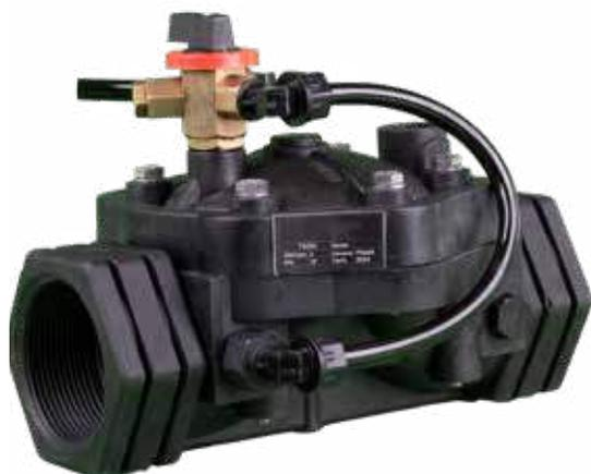
As válvulas controladas manualmente são válvulas de controle hidráulico operadas pela pressão da linha e fornecem miniválvulas de 3 vias para operação liga-desliga. A válvula tem uma pressão de abertura mínima de 0,7 bar. Graças ao seu Diafragma flexível, ela realiza uma operação de verificação fácil e rápida em aplicações de alta pressão e é desligada sem impacto.
