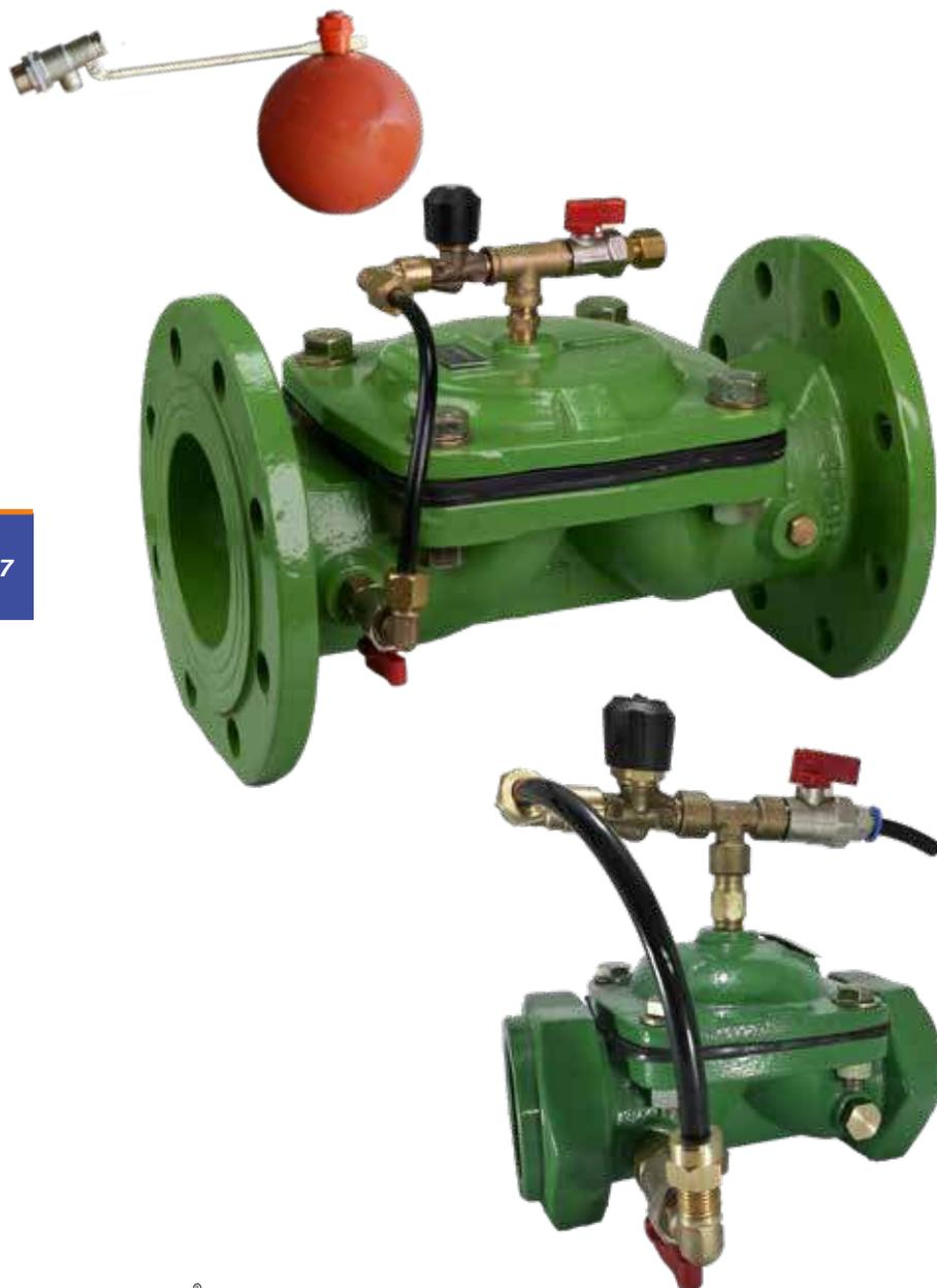
A válvula de controle de nível de flutuação é a válvula de controle hidráulico projetada para controlar continuamente o nível de água em reservatórios e tanques. A válvula principal é controlada manualmente pela válvula piloto de flutuação do tipo modulante de 2 vias.
