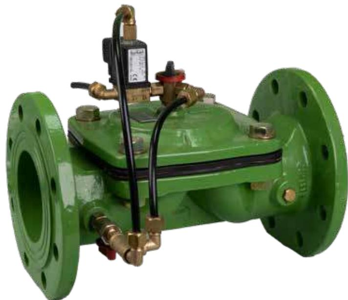
A válvula controlada por solenoide é a válvula de controle hidráulico operada pela pressão da linha e projetada para garantir o processo de abertura/fechamento por meio de válvulas piloto solenoides de 3/2 vias integradas, controladas remotamente com sinal elétrico. O sinal elétrico para as válvulas piloto solenoides é garantido por meio de um dispositivo de controle, relé de tempo, interruptor principal e unidades de controle PLC etc.
