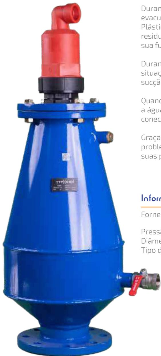
Durante a primeira inicialização do sistema, ele permite que a grande quantidade de ar na tubulação seja rapidamente evacuada do sistema. Quando a água atinge a esfera da ventosa de águas residuais, a boia de ação dupla da ventosa da Plástico presa à esfera se levanta e fecha a saída da ventosa. Assim, devido ao ar comprimido preso em seu interior, a água residual é fechada antes de chegar à ventosa Plástico. Os elementos de vedação da ventosa Plástico continuam cumprindo sua função.
