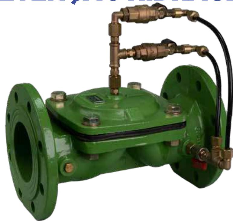
A válvula de retenção hidráulica é uma válvula de retenção controlada hidráulicamente que opera com a pressão da linha e evita o refluxo no sistema. Quando o valor da pressão a jusante excede o valor da pressão a montante, a válvula é fechada como se estivesse totalmente vedada sem causar surtos.
