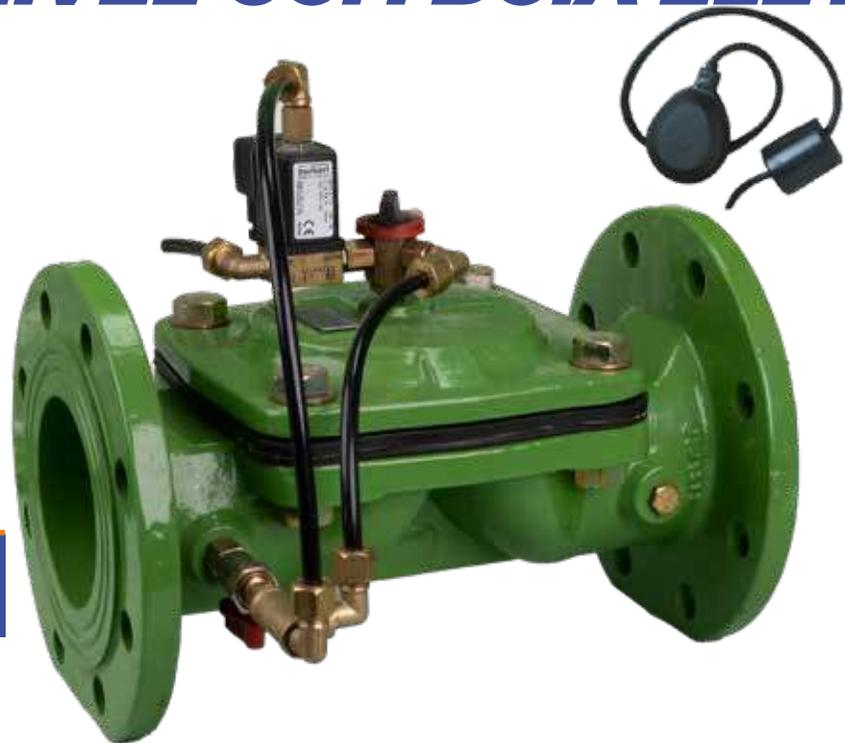
A Válvula de Controle de Nível de Boia Elétrica é uma válvula que controla constantemente o nível de água por meio de uma boia elétrica colocada no tanque. Quando o nível de água no fundo cai abaixo do valor desejado, o flutuador elétrico envia um sinal para a bobina do solenoide na válvula principal.
