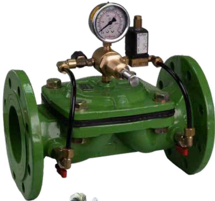
La válvula de control reductora de presión controlada por solenoide es una válvula de control hidráulica que reduce el valor de presión de entrada al valor de presión deseado. El control de la válvula principal se efectúa mediante bobinas de solenoide montadas en ella.
