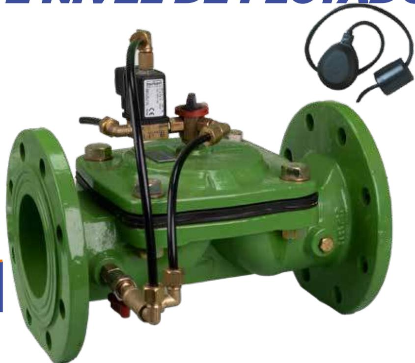
La válvula de control de nivel por flotador eléctrico es una válvula que controla constantemente el nivel del agua mediante un flotador eléctrico colocado en el depósito. Cuando el nivel de agua en el fondo cae por debajo del valor deseado, el flotador eléctrico envía una señal a la bobina de solenoide de la válvula principal.
