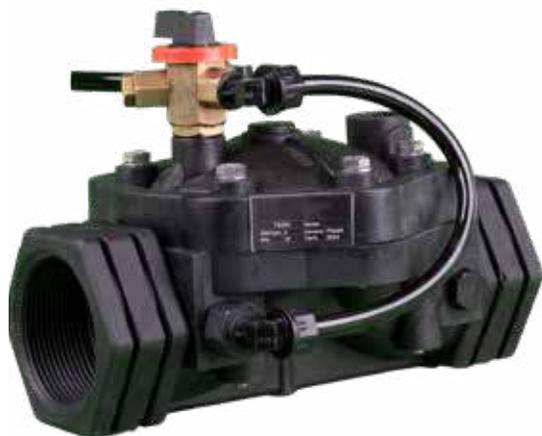
Las válvulas de control manual son válvulas de control hidráulico que se accionan mediante la presión de la línea y proporcionan miniválvulas de 3 vías para el funcionamiento de encendido y apagado. La válvula tiene una presión de apertura mínima de 0,7 bar. Gracias a su Diafragma flexible, realiza una operación de control fácil y rápida en aplicaciones de alta presión y se cierra sin impacto.
