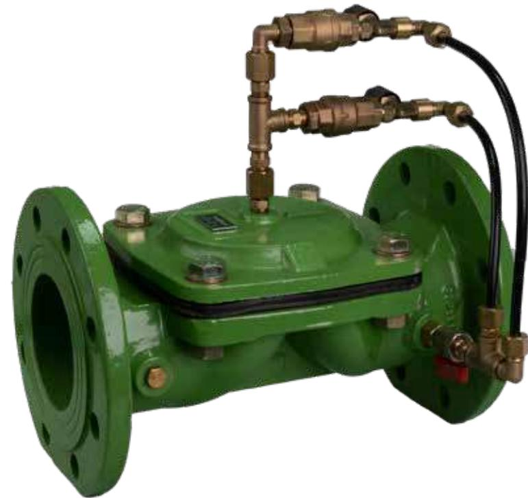
La válvula de retención hidráulica es una válvula de retención controlada hidráulicamente que funciona con la presión de la línea y evita el refluo en el sistema. Cuando el valor de la presión aguas abajo excede el valor de la presión aguas arriba, la válvula se cierra completamente sin causar sobretensión.
