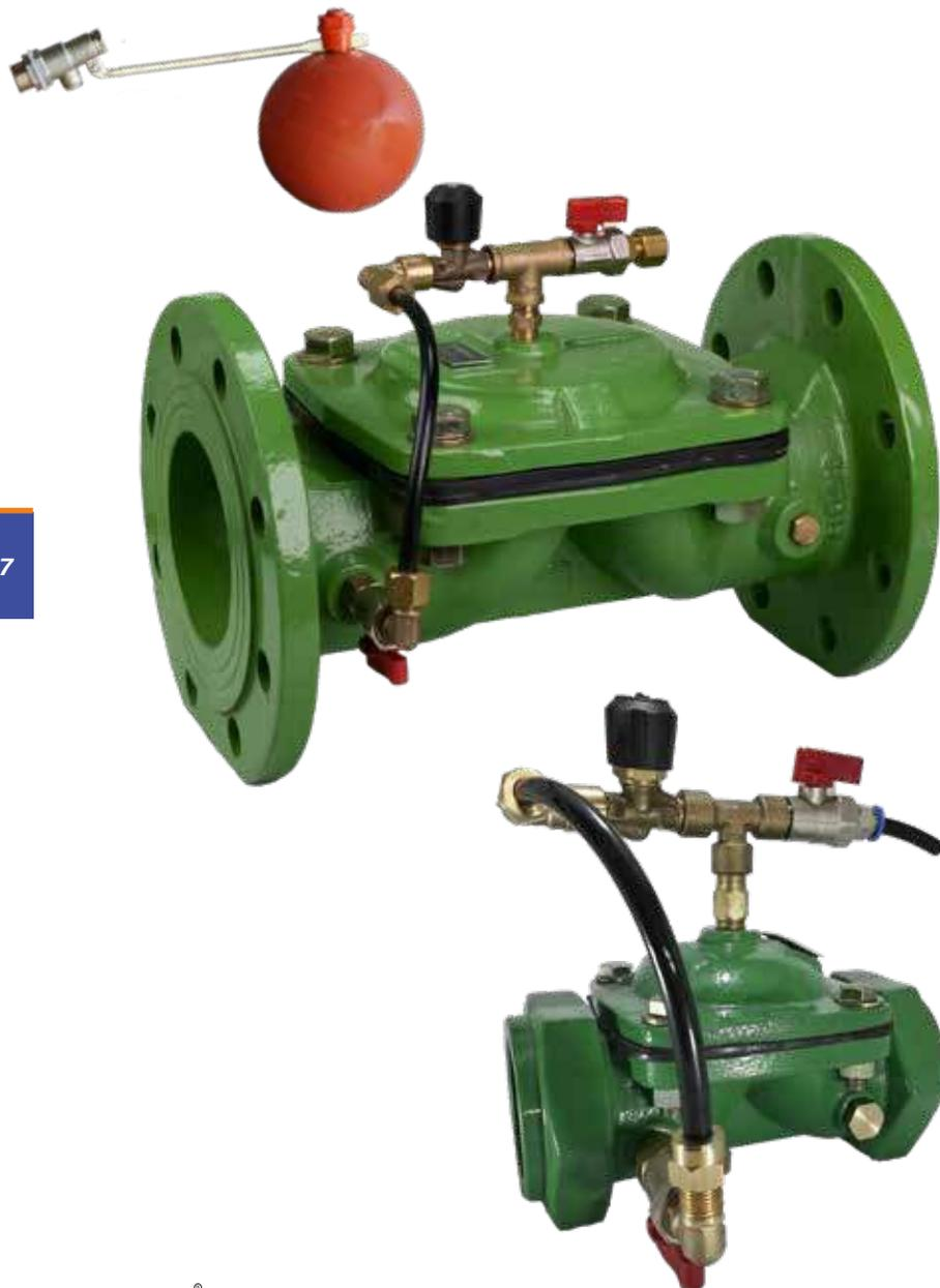
La válvula de control de nivel de flotador es una válvula de control hidráulica diseñada para controlar continuamente el nivel de agua en depósitos y tanques. La válvula principal es controlada manualmente por la válvula piloto de flotador de tipo modulante de 2 vías.
